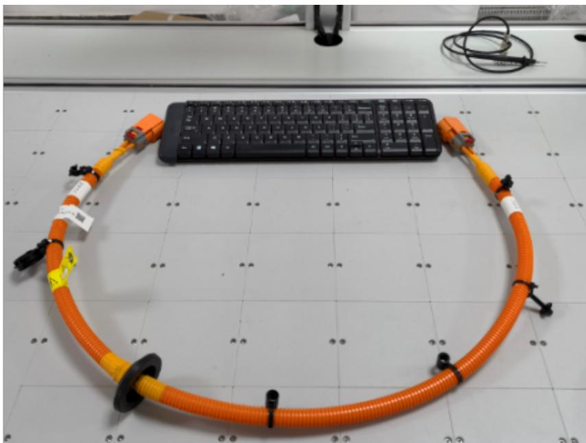
新能源高压线束测试系统主要用于线缆线束的设计、生产以及检验测试。测试主要针对复杂线缆线束的导通、绝缘、耐压及元器件性能指标的测试和检验等。线束测试是对电路中连接各电器设备的接线部件以及绝缘包扎材料等进行测试，以找出可能的问题，一般需要测量线束的导通，绝缘，耐压，电阻，常见的故障有：导线之间的短路、断路、漏接，误配线，接触不良，导线整体绝缘耐压等级故障。线束的测试主要分两大部分，一部分主要集中在低压测试，这一类主要要求是多点位、高速、编辑的方便性。别一类增加了高压和电阻方面的测试，一般点位相对前面一种要少。北京汽车高压线束测试仪多少钱从新能源高压线束测试系统技术参数上能看出一个公司在产品之初的设计理念。
